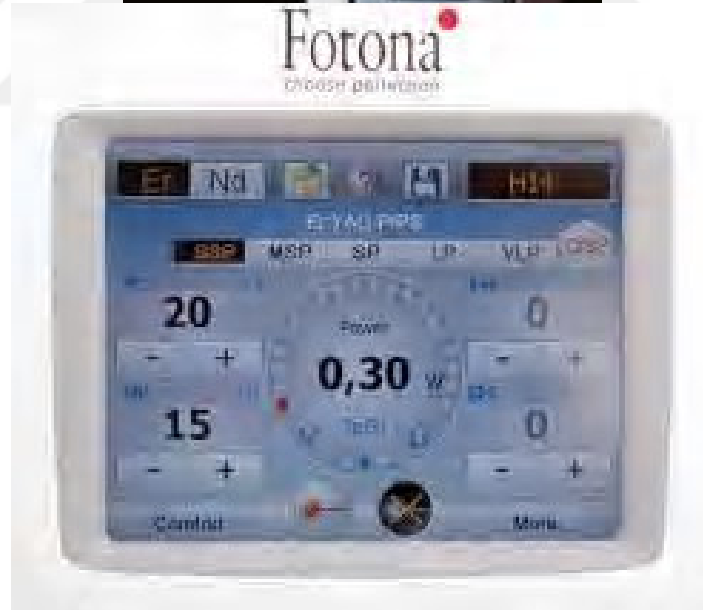
řekil 2.8: Solda: Fotona cihazı ( www.fotona.com ). Sađda: PIPS kullanımını için ayarlanmıř fiziksel parametrelerin ekran grnts (146).
