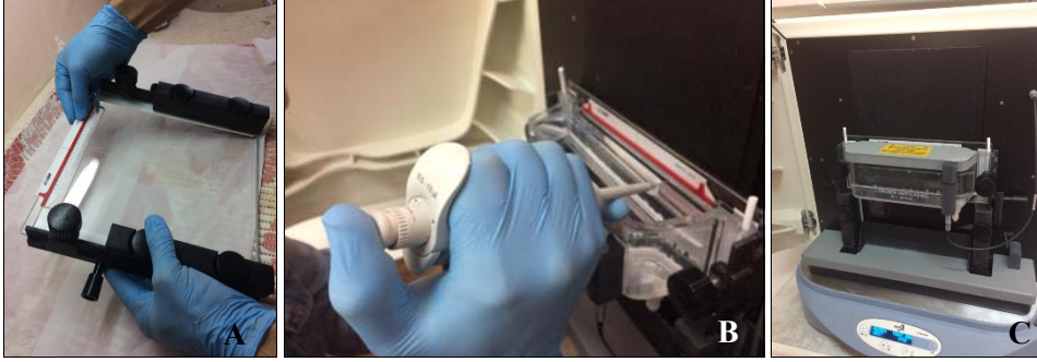
Şekil 3.11. Poliakrilamid jel hazırlanması ve Li-Cor elektroforez cihazının görüntüsü.
