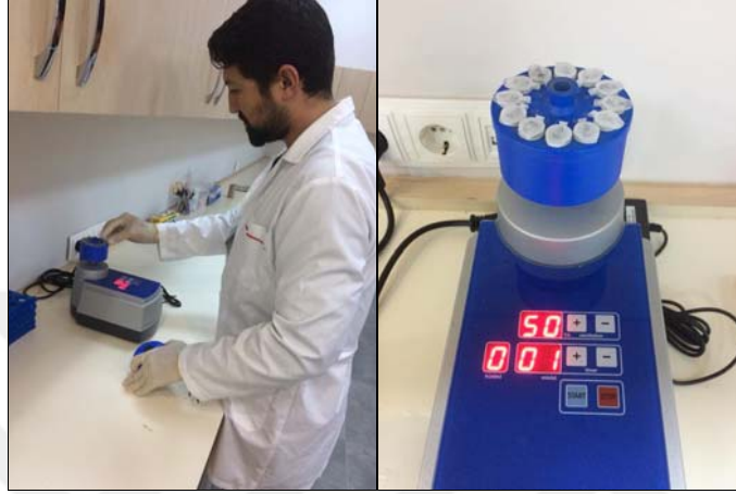
Şekil 3.7. Bitkisel materyale ait yaprak örneklerinin Tissue-Lyser cihazında öğütülmesi.
