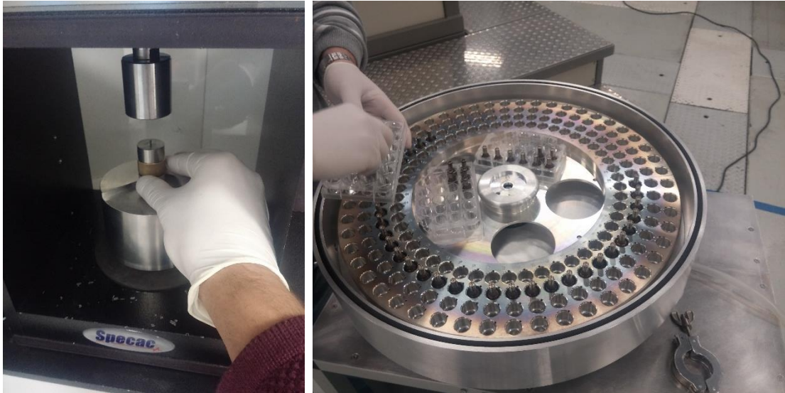
Figure 2.6 Cathoding process, France (Centre National de la Recherche Scientifique, CEREGE)
