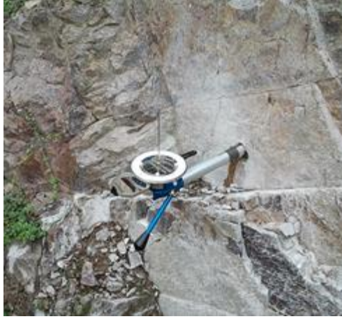
Şekil 1.3.2 : Paleomanyetik karot örneğinin yönlendirme sistemi a) Arazi örneği; b) Şematik gösterimi (Butler, 1992).
