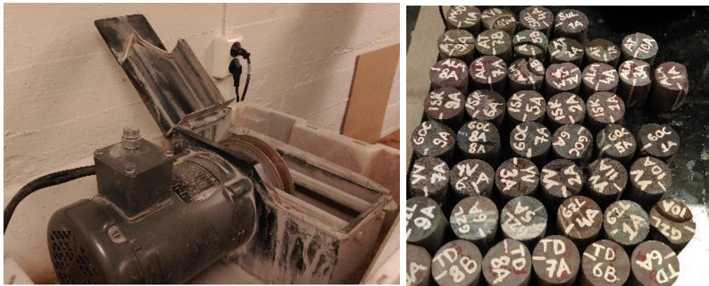
Şekil 1.3.3 : Paleomanyetik karot örneğinin kesme işleminde kullanılan ekipman ve ölçüme hazırlanmış standart paleomanyetik numuneler.
