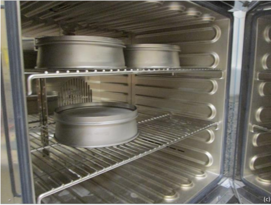
Şekil A.3 : (a) Ultrasonik banyo ve distile su, (b) Fırın, (c) Fırında kurutulmuş elekler.
