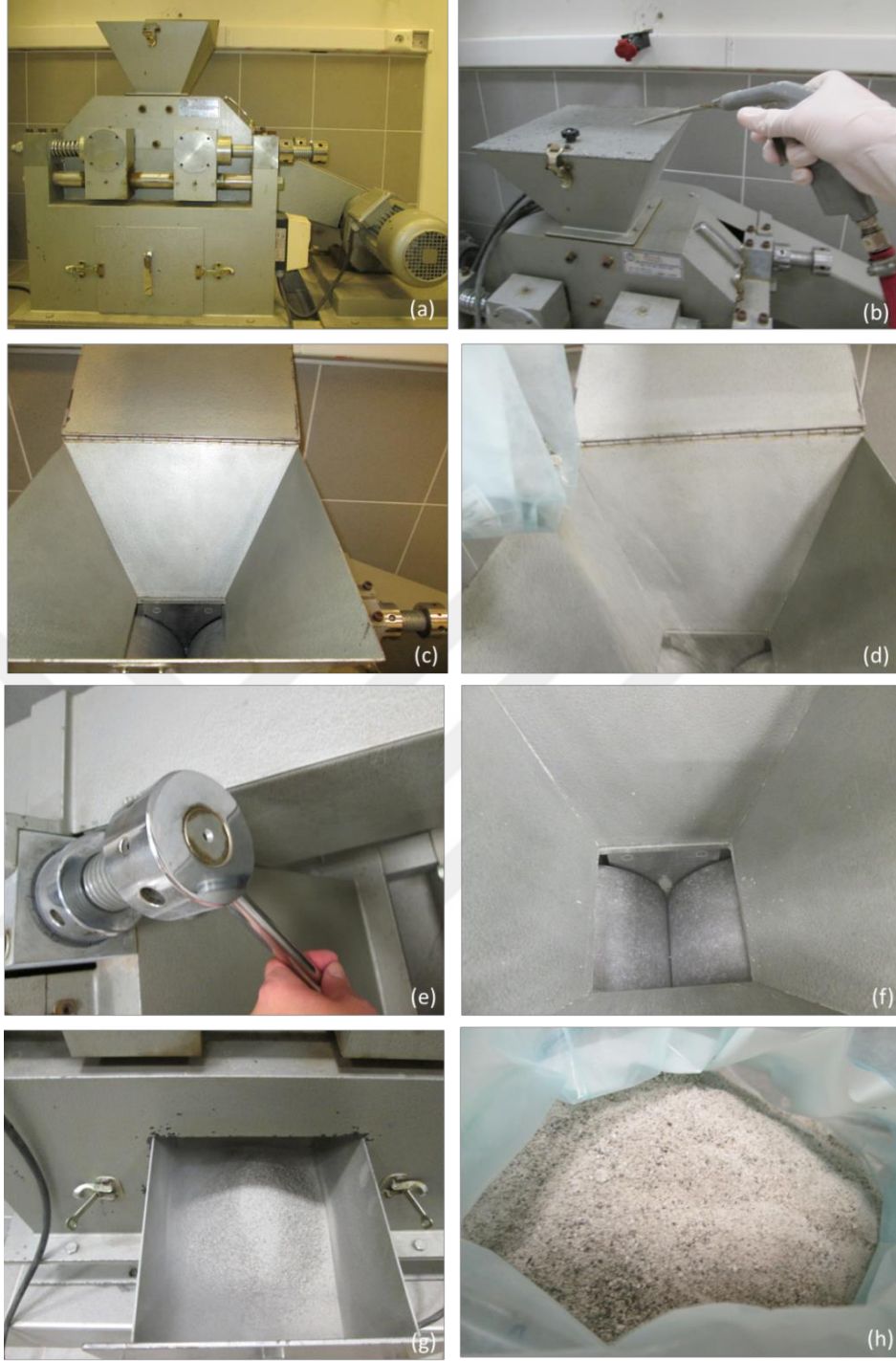
Şekil A.2 : (a) Taş öğütme makinesi, (b) Hava kompresörü, (c) Silindir, (d) Numunenin döküldüğü yer, (e) Anahtarla silindir aralığının daraltılarak sabitlenmesi, (f) İyice daraltılan silindir aralığı, (g) Numunenin alındığı çekmece, (h) Taş öğütme makinesinden alınan numune.
