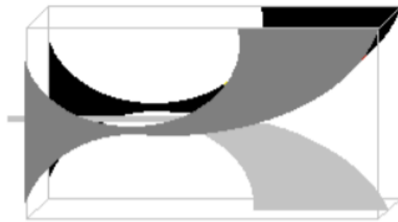
Şekil 3.11 : Dengelenmiş zıt kutuplu vivaldi anten yapısı
