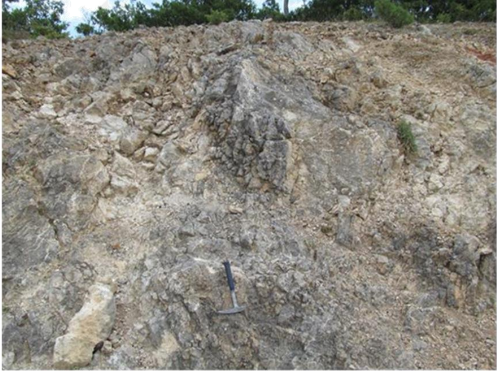
Şekil 2.11: Oldukça parçalanmış, iç yapıyı bozulmuş kireçtaşı (Karsavul ve Arpaderesi köyleri).
