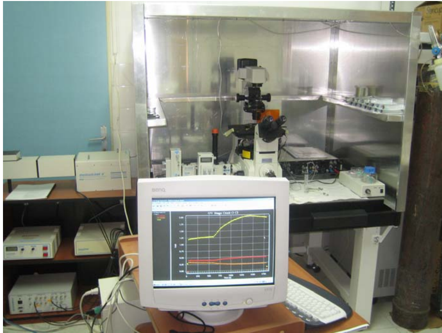
Şekil 3.5. Kayıtların alındığı TIBDAM laboratuvarındaki mikrospektrofluorometre sistemi.
