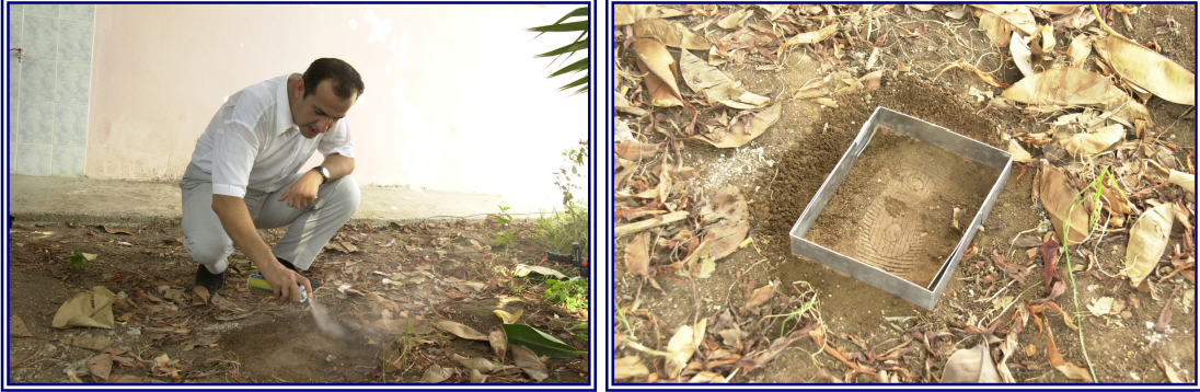
Şekil 22. İzin bulunduğu bölgeye daha sonra hazırlanıp dökülecek dişi alçısının toprakla bütünleşmesini engellemek amacıyla 15-20 cm mesafeden sertleştirici sprey sıkıldı ve dökülecek alçının taşmaması için çerçeve yerleştirildi.
