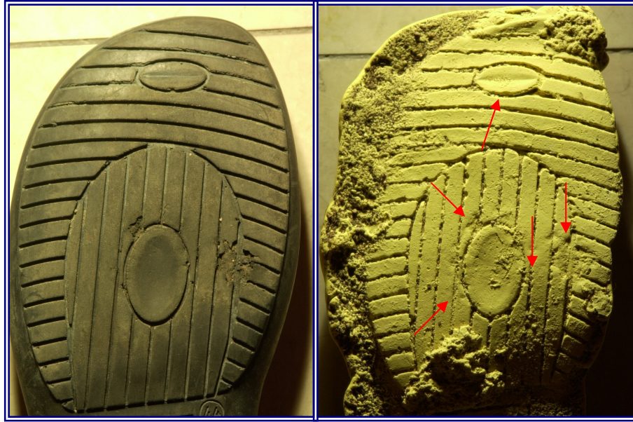
Şekil 27. Şüpheli ayakkabının pençe bölümü ile olay yerinden alınan ayakkabı izinin kalıbı üzerindeki karakteristik özellikler karşılaştırıldı.
