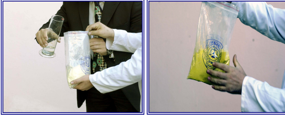
Şekil 23. 1 kg dişi alçısı üzerine yaklaşık 370 ml. su ilave edildi ve bu bileşenler 4-5 dakika süreyle karıştırıldı.
