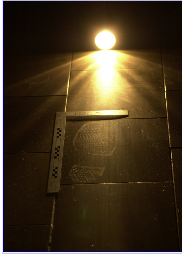
Şekil 3. Odanın karartılması ve zemine yakın mesafeden bir ışık kaynağı kullanılması halinde birçok ayakkabı izi görünür hale getirilebilir.
