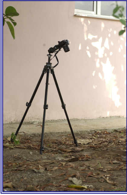
Şekil 30. Soldaki fotoğrafta; tripod üzerine yerleştirilen fotoğraf makinesinin ayakkabı izinin fotoğrafını 90 derecelik açı (yere paralel) ile çekmediği için, sağdaki fotoğraftaki görüntü ortaya çıkmıştır.
