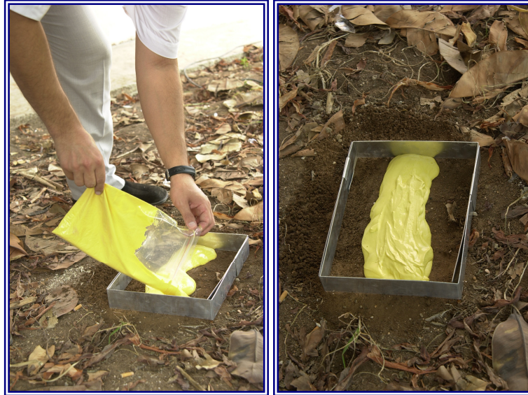
Şekil 24. Hazırlanan karışım iz üzerine 7-8 cm. mesafeden mümkün olduğunca hızlı bir şekilde döküldü ve alçı kurumaya bırakıldı.
