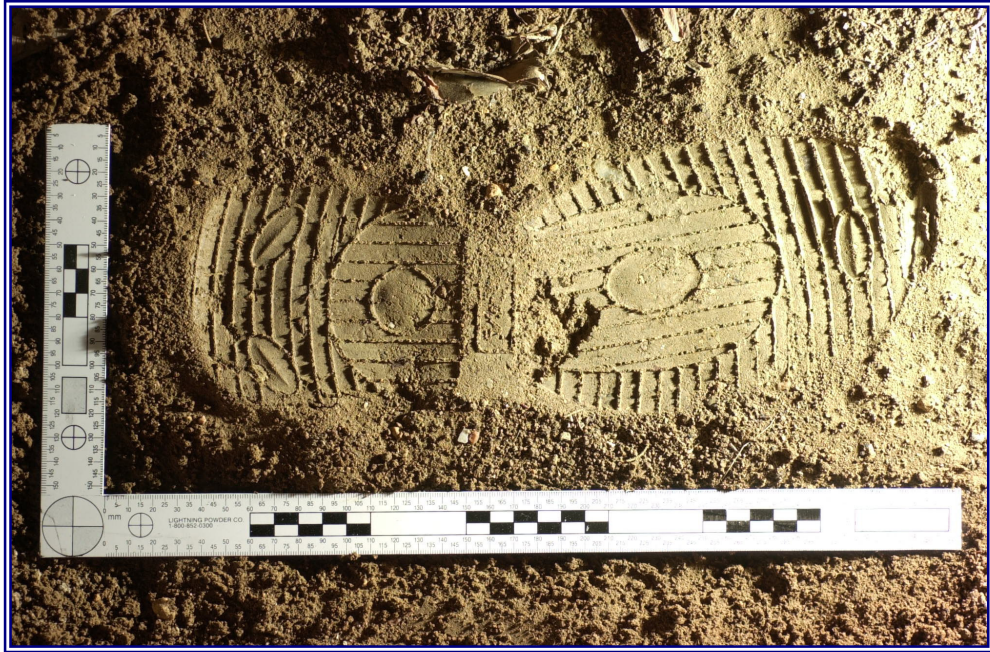
Şekil 19. Ayakkabı izinin bulunduğu bölge günışığından arındırıldıktan sonra, izin sağ tarafından 30 derecelik yatay açıyla ışık verilmesi sonucunda oluşturulan, inceleme kalitesinde çekilmiş fotoğraf.
