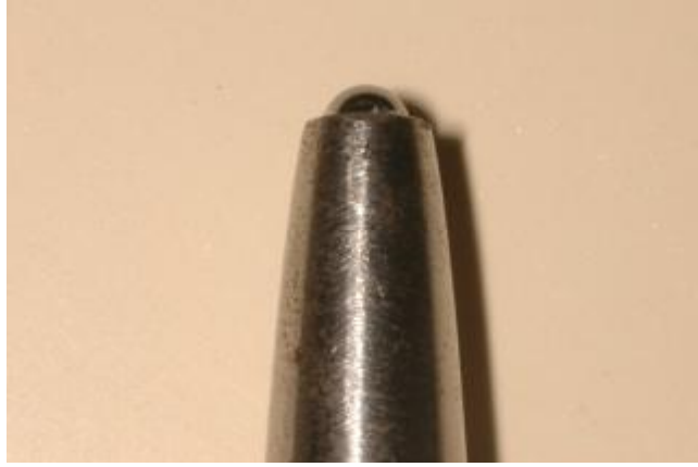
řekil 3.10 Ykleme ucu. 3, 98 mm apında tungsten karbid bilye ykleme ucuna sabitlenmiřtir.
