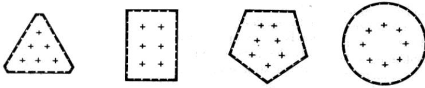
Şekil 4.18. Çerçevesiz tüp için uygun plan formları (Bal, 2003).
