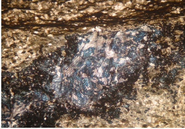
Şekil 5.4. Emir formasyonundan alınan örneğe ait ince kesit görüntüsü. Metakumtaşı (kuvars vake) erime ile genişletilmiş gözenek alanları kalsit, ferroan ve dolomit dolgulu. Ol. 40X
