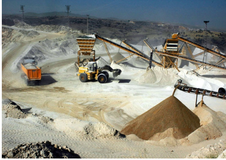
Şekil 6.4. Keçikaya formasyonunda açılan Alkar taş ocağında çalışan Konkasör balast bandı
