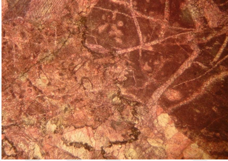
Şekil 5.36. Permiyen yaşlı kireçtaşı bloklarından alınan örneğe ait ince kesit görüntüsü. Seyrek dolomitli kireçtaşında (seyrek dolomitli intrasparit) stilolitik yol boyları demirli-killi maddeler ile dolu. OI.40X
