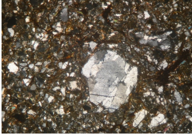
Şekil 5.10. Elmadağ formasyonundan alınan örneğe ait ince kesit görüntüsü. Kumtaşı–kuvars vake (az yuvarlaklı, irili ufaklı kuvars taneli). PI. 40X
