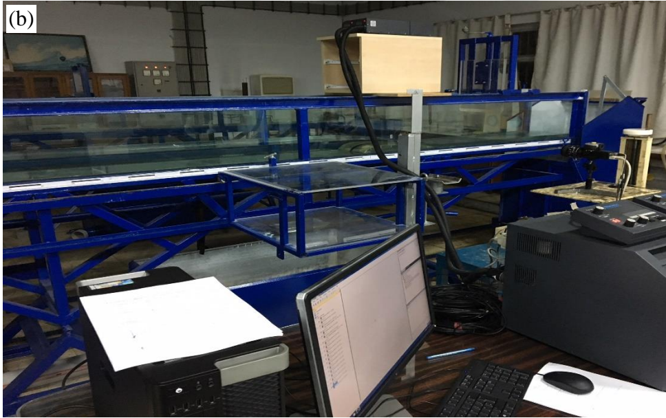
Şekil 3.2. Deneş düzeneđi; (a) LDA ölçüm sistemi, (b) PIV ölçüm sistemi
