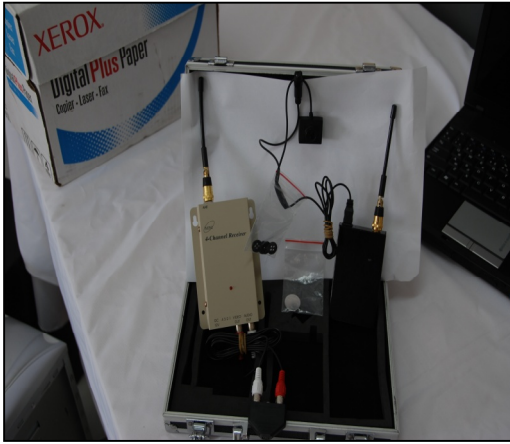
Şekil 1. ATM cihazına takılan kablosuz kamera sistemi
