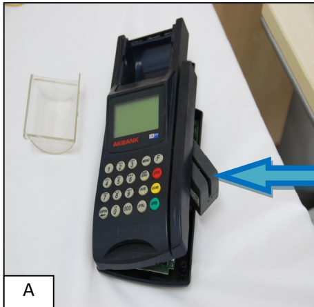
Şekil 6. POS Cihazı: A. POS cihazı içine şifre kopyalama cihazı yerleştirilmiş, B. Sökülmüş hali
