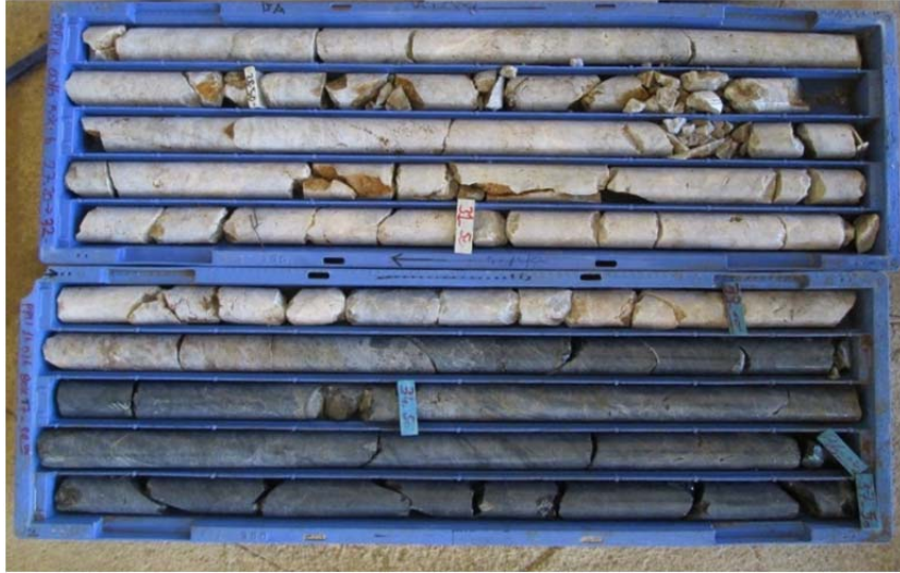
Őekil 4.19. Rekristalize kireçtaŐının koyu gri kireçtaŐına geçiŐinin karot görünümü
