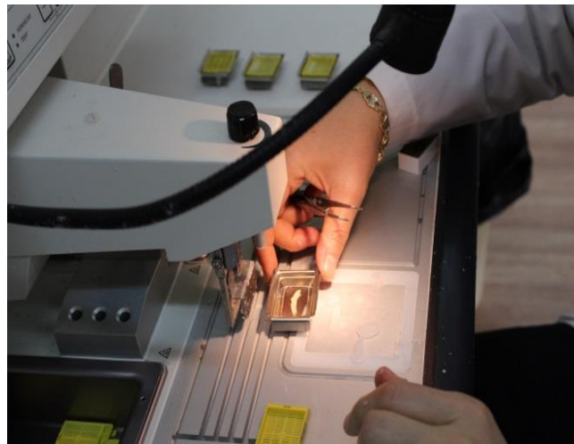
Şekil 3.17. Kesiti alınmış dişlerin bloklanması.
