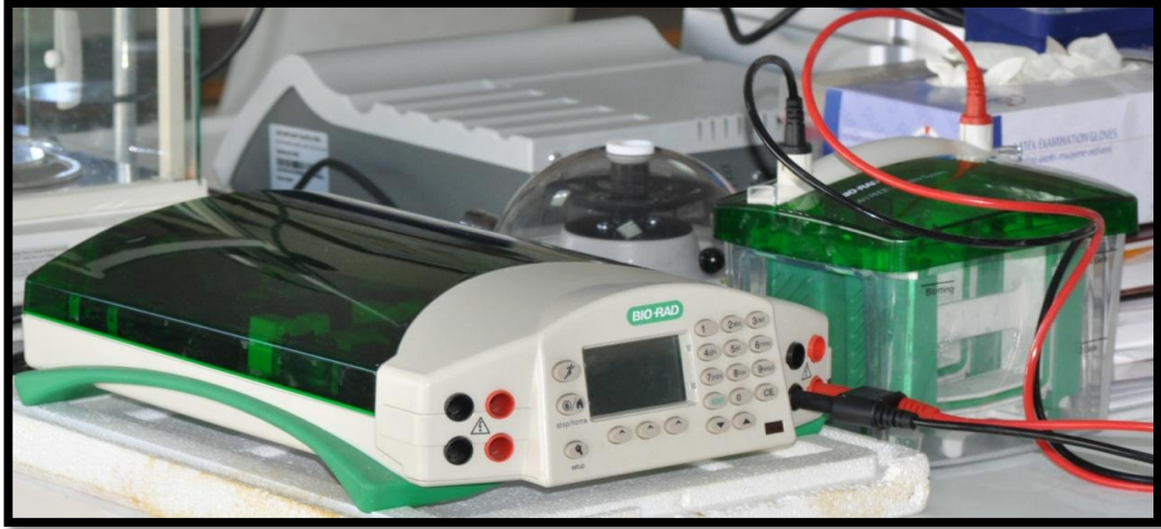
Şekil 3.10. Jel-Elektroforez için kullanılan düzenek (Bio Rad-Amerika Birleşik Devletleri)
