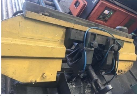
Şekil 5.10. Testerede koruyucu muhafaza uygulaması
