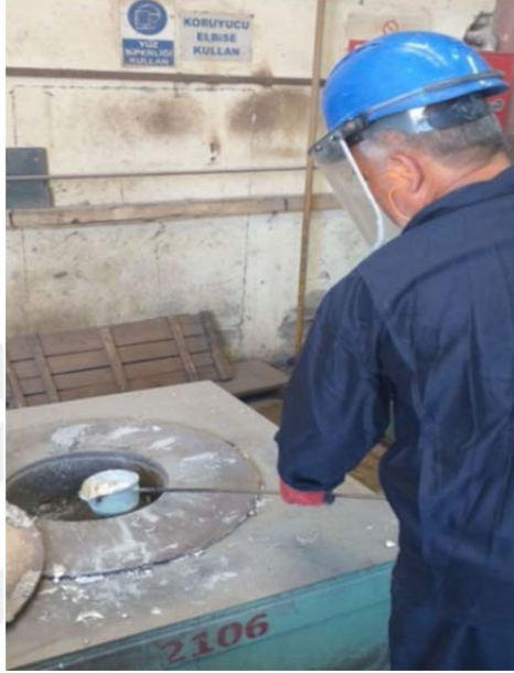
Şekil 5.7. Yanmaz koruyucu elbise uygulaması
