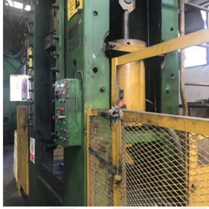
Şekil 5.11. Dövme tezgahı ve koruyucu tertibat uygulaması
