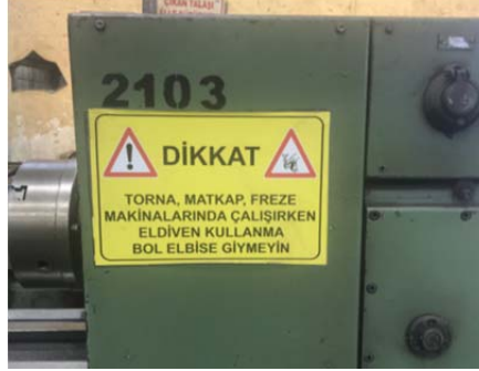
Şekil 5.18. İmalat atölyesi uyarı levhası uygulaması
