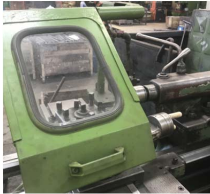
Şekil 5.19. Tornado koruyucu muhafaza uygulaması
