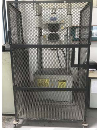
Şekil 5.37. Çekme cihazı koruma kafesi uygulaması
