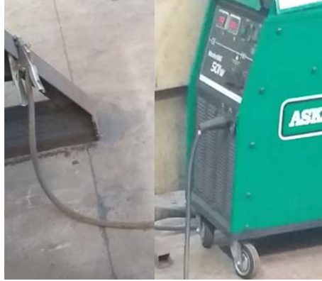
Şekil 5.25. Kaynak pensesi izolasyonu
