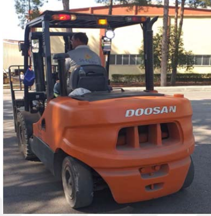
Şekil 5.40. Forkliftlerde sesli, ışıklı ikaz sistemi
