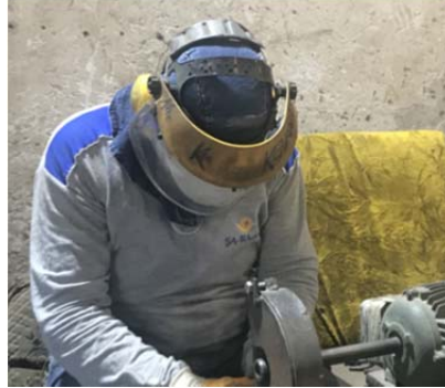
Şekil 5.22. Koruyucu yüz siperi ve toz maskesi uygulaması
