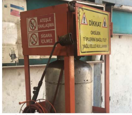
Şekil 5.17. Oksijen tüpü uyarı levhası uygulaması
