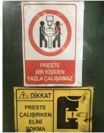
Şekil 5.14. Dövme tezgahı uyarı levhası uygulaması
