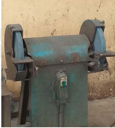
Şekil 5.9. Koruyucu muhafaza uygulaması
