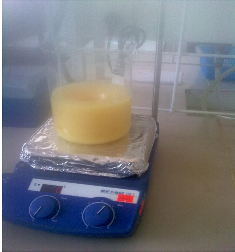
Şekil 11. Propolis sıvı özütünün manyetik karıştırıcıda hazırlanışı.
