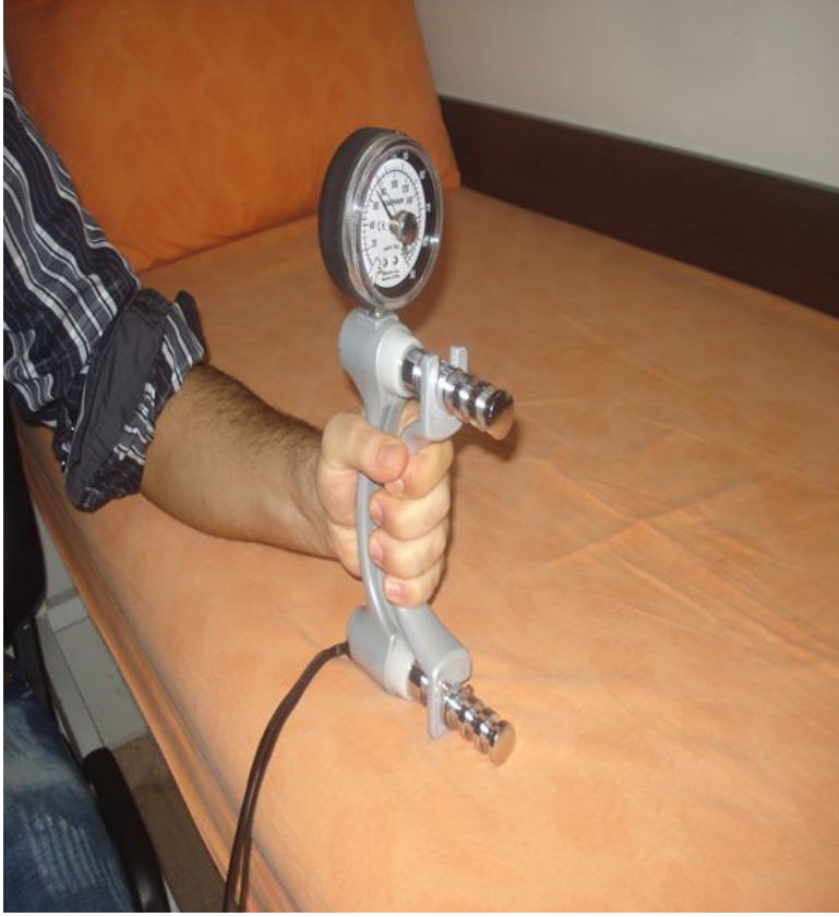
Şekil 12: Kavrama Kuvvetinin Ölçülmesi
