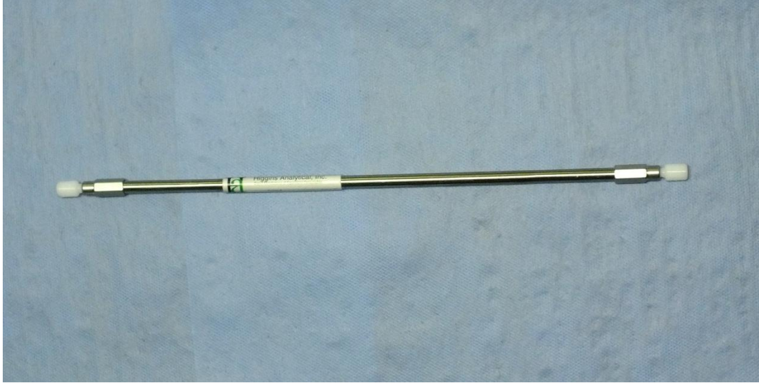
Şekil 3.11: C18 ters faz analitik kolon
