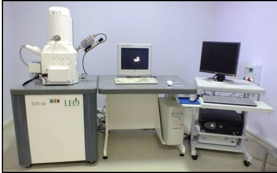
Şekil 3.5: Mineral analizinin yapıldığı EDX ve yüzey görüntülerinin alındığı SEM'in görüntüsü.
