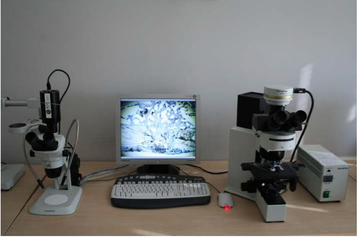
Şekil 3.11 Histomorfometrik analiz istasyonu.
