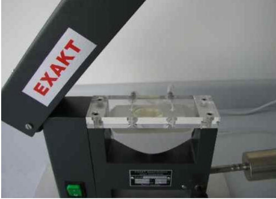
Şekil 3.8. Pleksiglas yapıştırma ünitesi.
