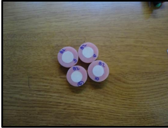
Şekil 3.6. Örneklerin akrilik kalıplar içine gömülmüş hali
