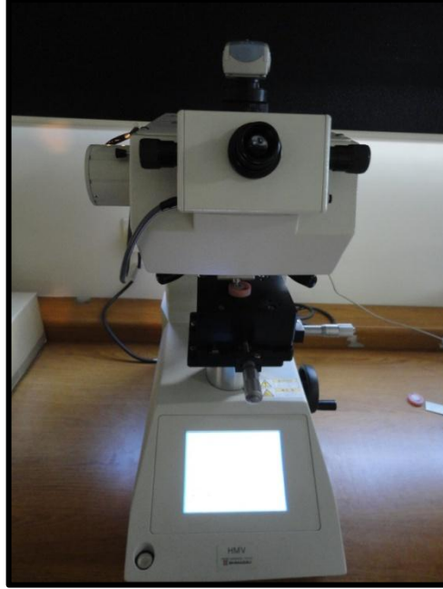
Şekil 3.8. Vickers micro sertlik cihazı ve örnek konumlandırılması
