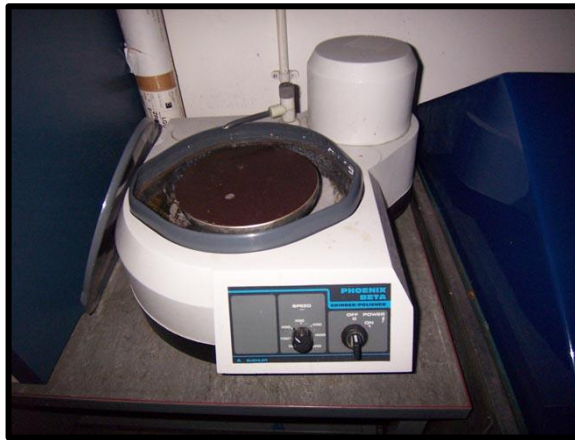
Şekil 3.7. Örneklerin parlatılmasında kullanılan cihaz
