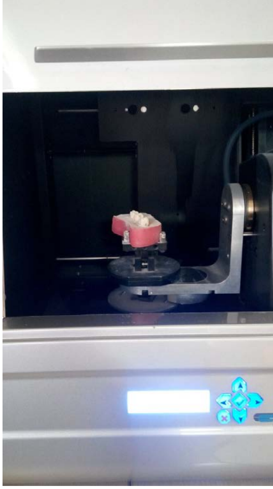
Şekil 3.10. Epoksi rezin modellerin cihaza yerleştirilmesi
