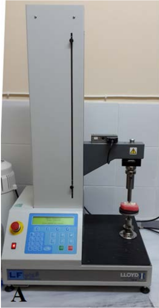
Şekil 3.19. A; Üniversal instron cihazı B; Basma testi sonucu kayıt örneği
