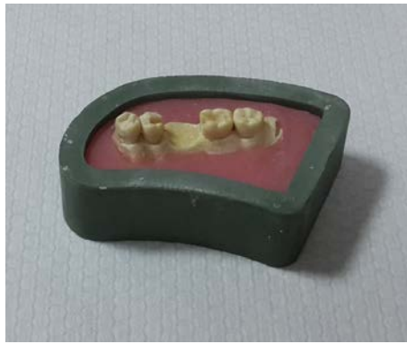
Şekil 3.8. Akrilik bloklara gömülen epoksi rezin modeller
