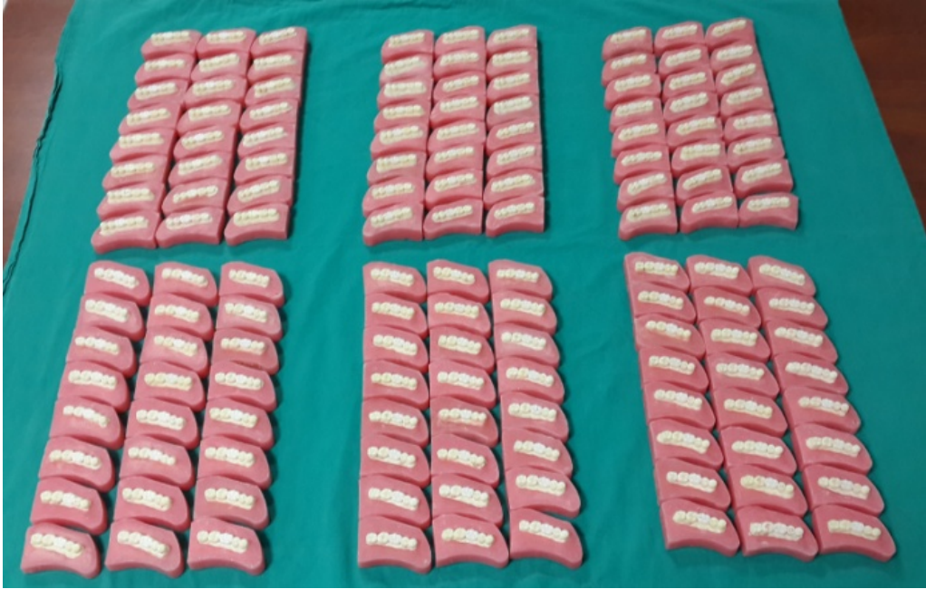
Şekil 3.17. Simantasyonları yapılan numuneler
