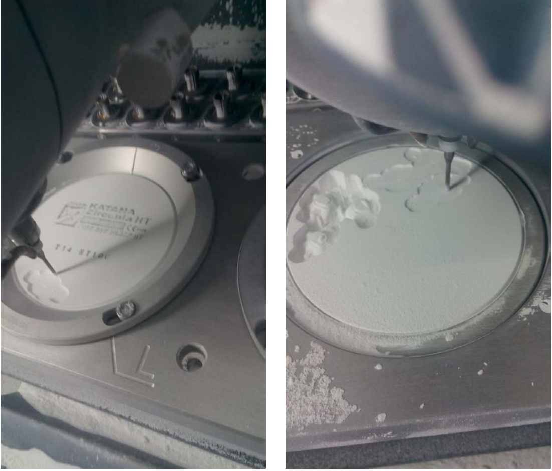
Şekil 3.14. CAD/CAM cihazına yerleştirilen zirkonya bloğun millenmesi
