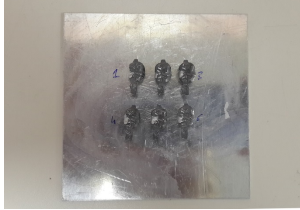
Şekil 3.20. SEM'le görüntü almak için kaplanan numuneler
