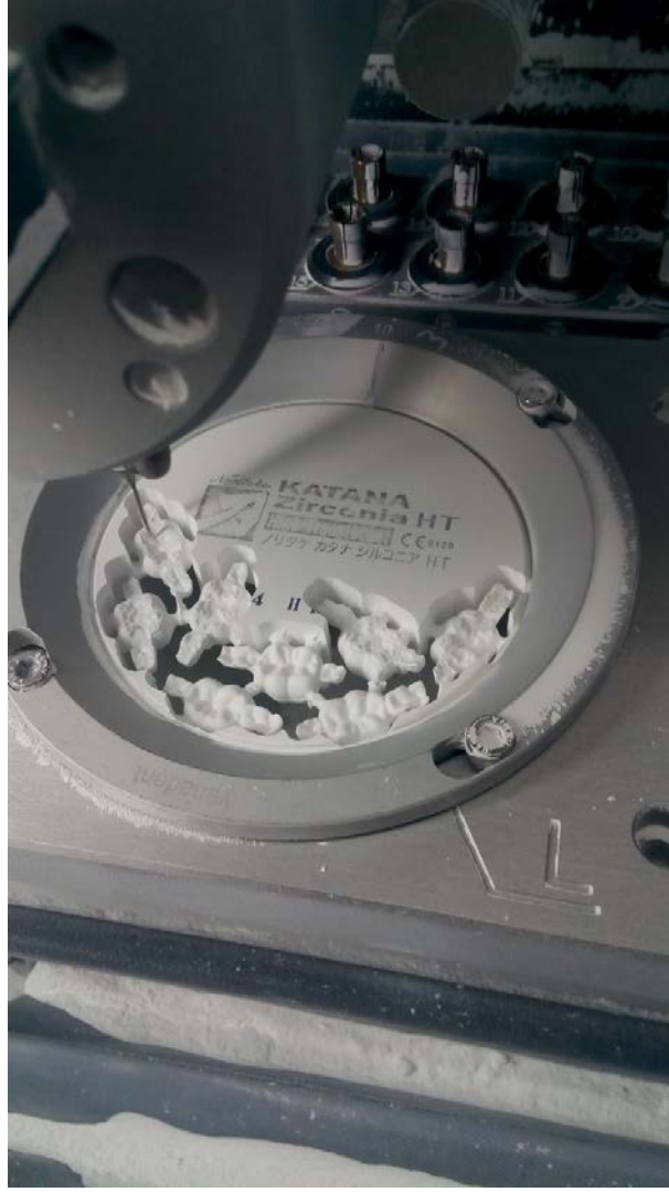
Şekil 3.15. Milleme sonucu restorasyonların oluşması
