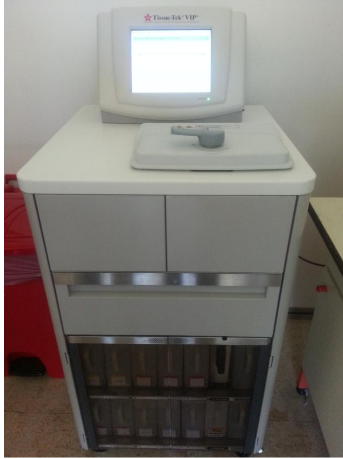
Şekil 3.19. Örneklerin dehidrate olmaları için bekletildikleri tam otomatik doku takip cihazı
