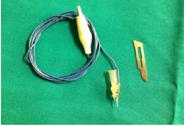
Şekil 3.3: Mental siniri uyarmak için üretilen stimülasyon elektrotu
