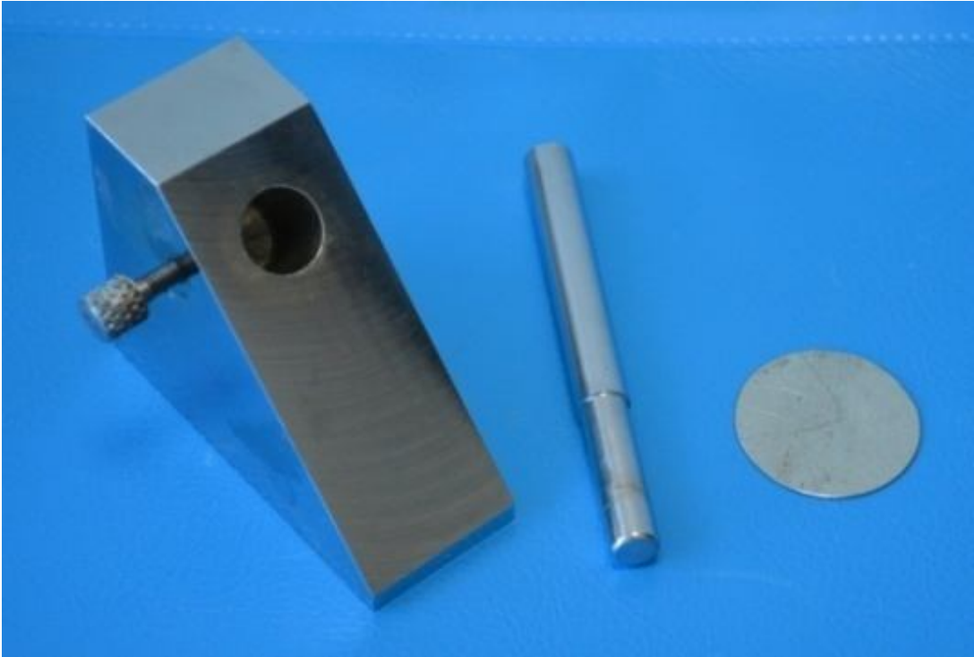
Şekil 3.18. Kırma testi için hazırlanan parçalar
