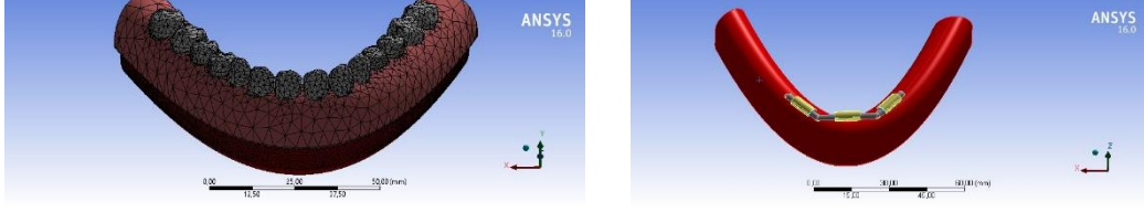
Şekil 3.16. 4 implant – bar tutuculu mandibular overdenture protez.
