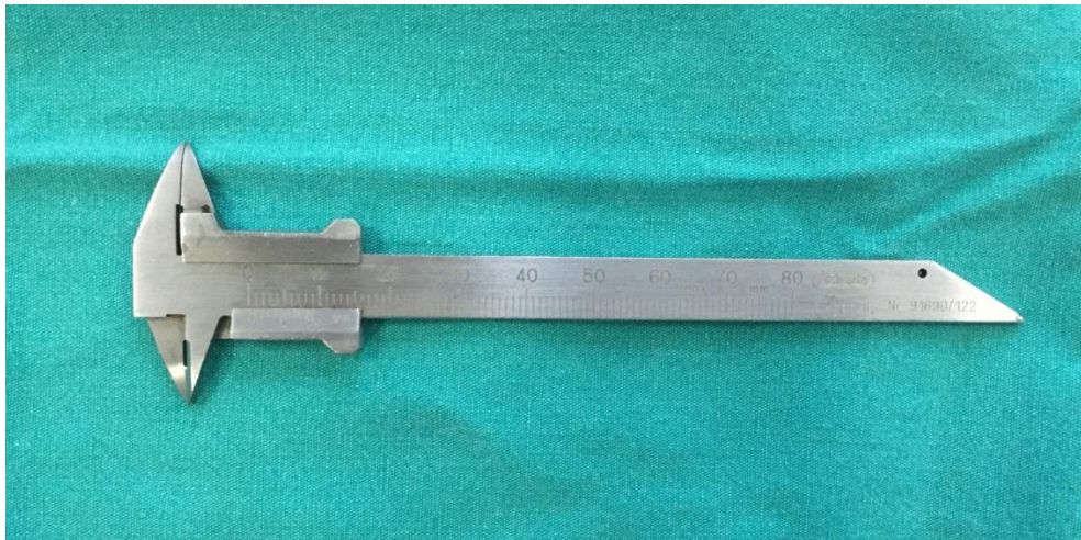
Şekil 3. 1. Deney bölümünde kullanılan kumpas
