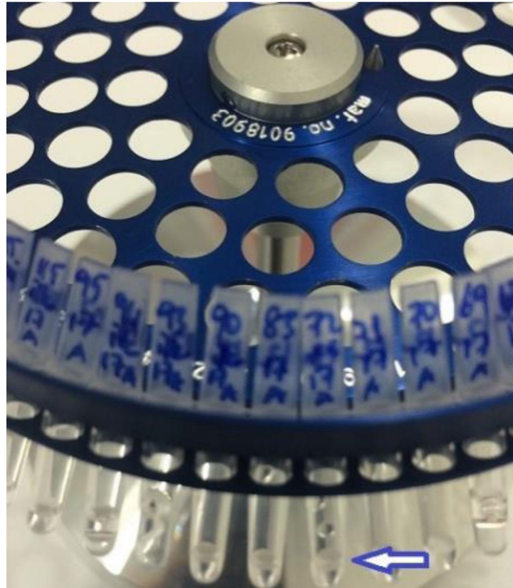
Şekil 3.7. Mavi ok ile gösterilen 0,1 µl'lik PCR tüpleri 72'lik özel tablasına etiketlenerek yerleştirildi ve bu tüplerde hazırlanan reaksiyonların her birinin hacmi 10 µl idi.
