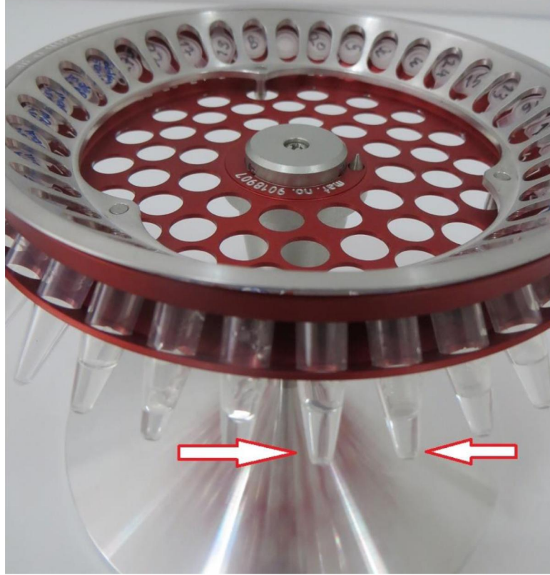
Şekil 3.8. Ok ile gösterilen 0,2 µl'lik PCR tüpleri 36'lık özel tablasına etiketlenerek yerleştirildi ve bu tüplerde hazırlanan reaksiyonların her birinin hacmi 25 µl idi.
