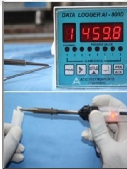
Şekil 2-6. Elektrotermal teknik ile debonding (134)
