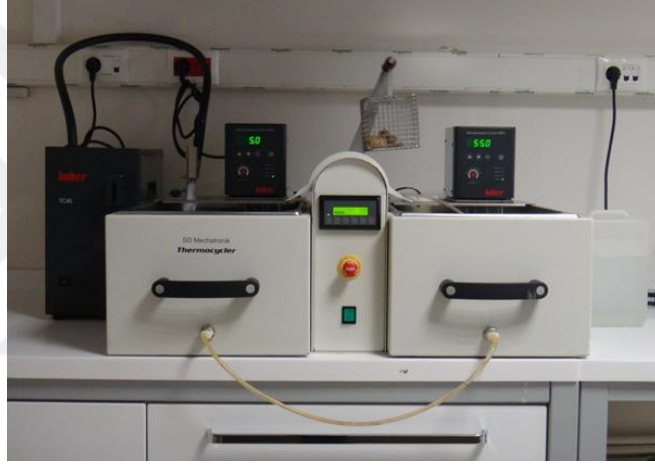
Şekil 3-8. SD mechatronik termal siklus cihazı
