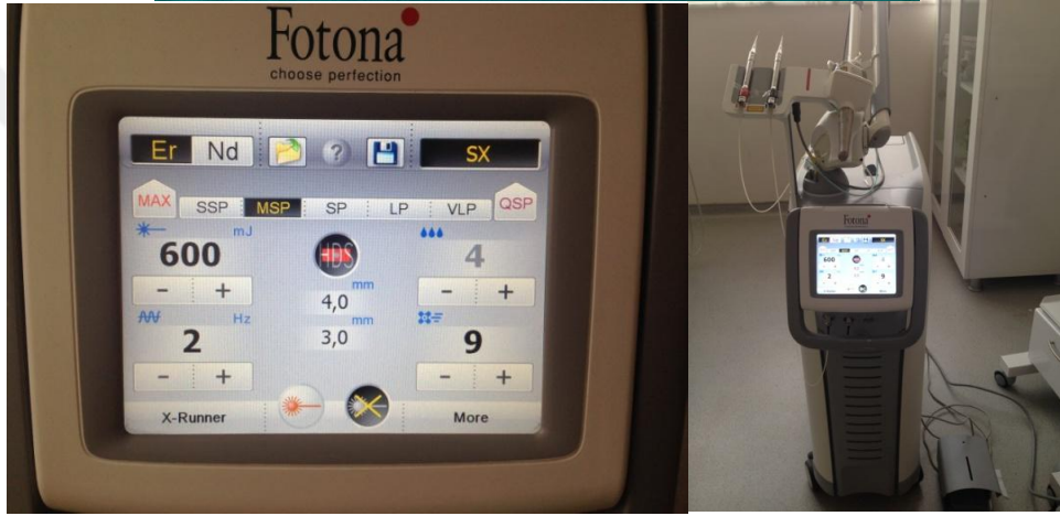
Şekil 3-10. Kullanılan lazer sistemi (Lightwalker, Fotona, Slovenya), çalışılan parametreler ve X-Runner dijital tarayıcı el aleti
