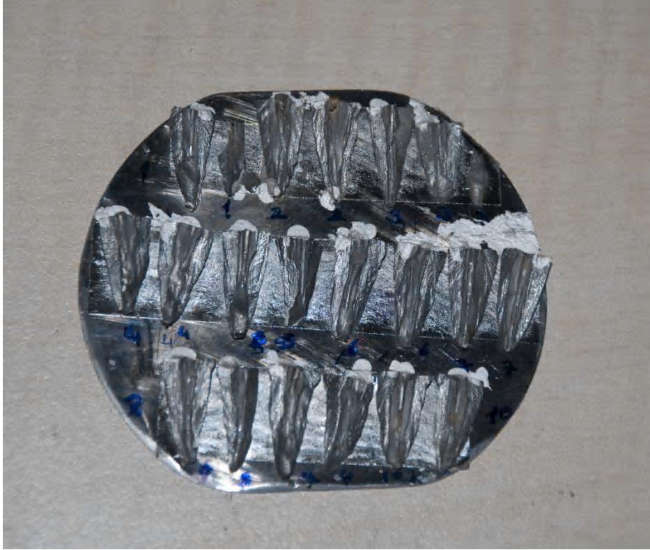
Şekil 3.2: Altın kaplanmış SEM örnekleri
