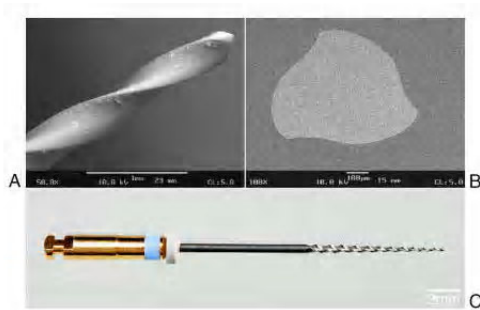
Şekil 2.7: Hero 642 sistemi fotoğrafları, A: Güvenli sonlanan uç tasarımı (SEM \times 50), B: Çapraz kesiti (SEM \times 200), C: Hero 642 sisteminin bir eđesi
