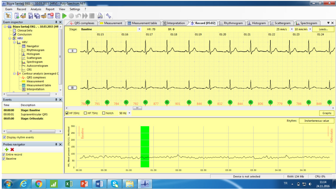
Şekil 3. 13. Poly-Spectrum EKG cihazı ile elde edilen 5 dakikalık kayıtların Neurosoft programında görünümü. Alt panelde 5 dakikalık kayıt süresince kalp hızı değişkenliğindeki değişimler sunulmuştur. Taralı alanın (yeşil renk) kapsadığı EKG kayıtları ise II. ve III. derivasyonlar için üst panelde gösterilmiştir. N-N' ler (yeşil yuvarlak kutucuklar) R-R aralıklarının normal olduğunu göstermektedir.
