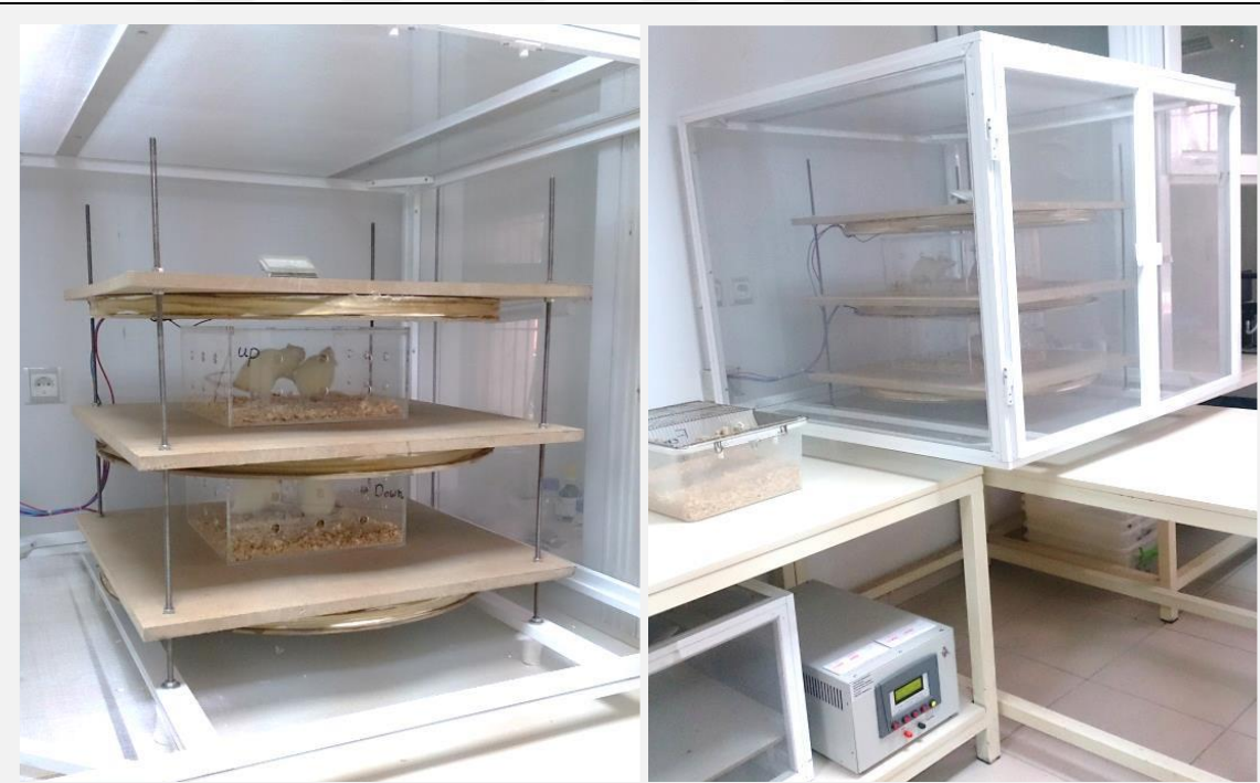
Şekil 3.6 Pulsu Manyetik alan sabit ve düzgün manyetik alanın oluşturulduğu üç bobinli bir sistem aracılığı ile uygulandı. Dışardan gelecek manyetik alanlar Faraday kafesi ile engellendi.
