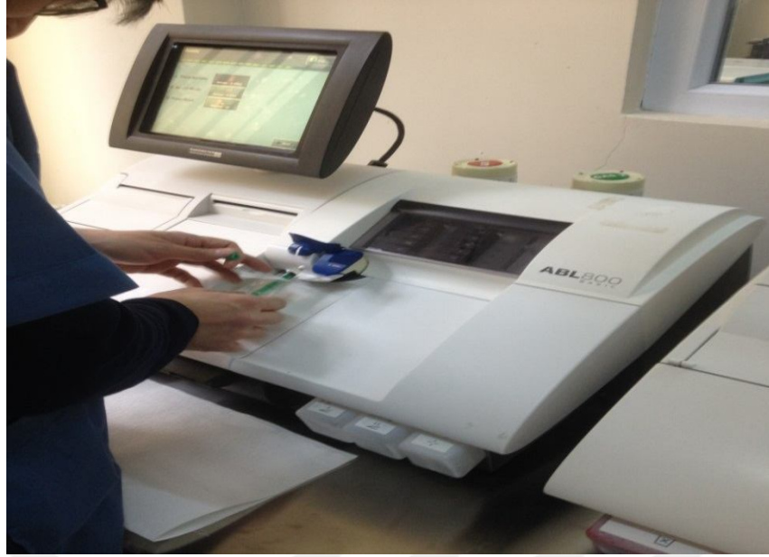
Şekil 3.8. ABL 800 Basic marka laktik asit ve kan gazları test cihazı
