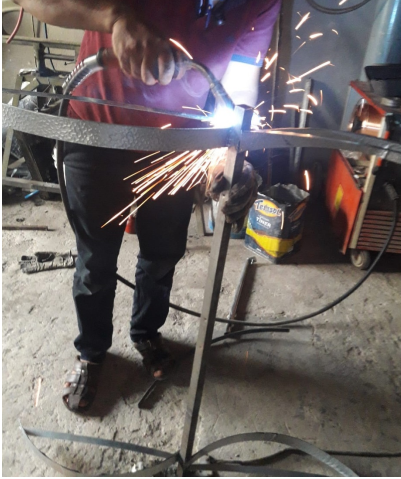
Şekil 3.32. Kanat iskeleti üretimi kaynak aşaması
