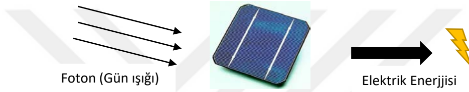
Şekil 3.18. Güneş pilinden elektrik üretim şeması
