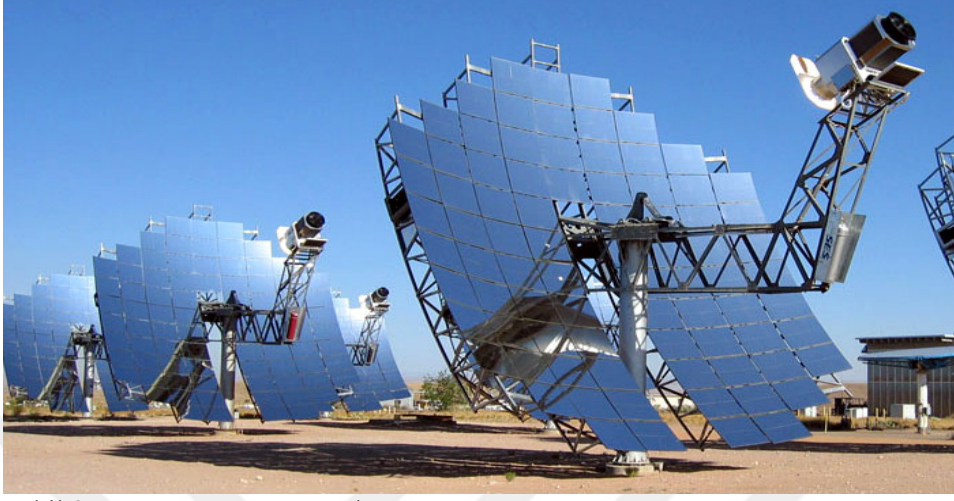
Şekil 3.6. Güneş Çanağı uygulaması
