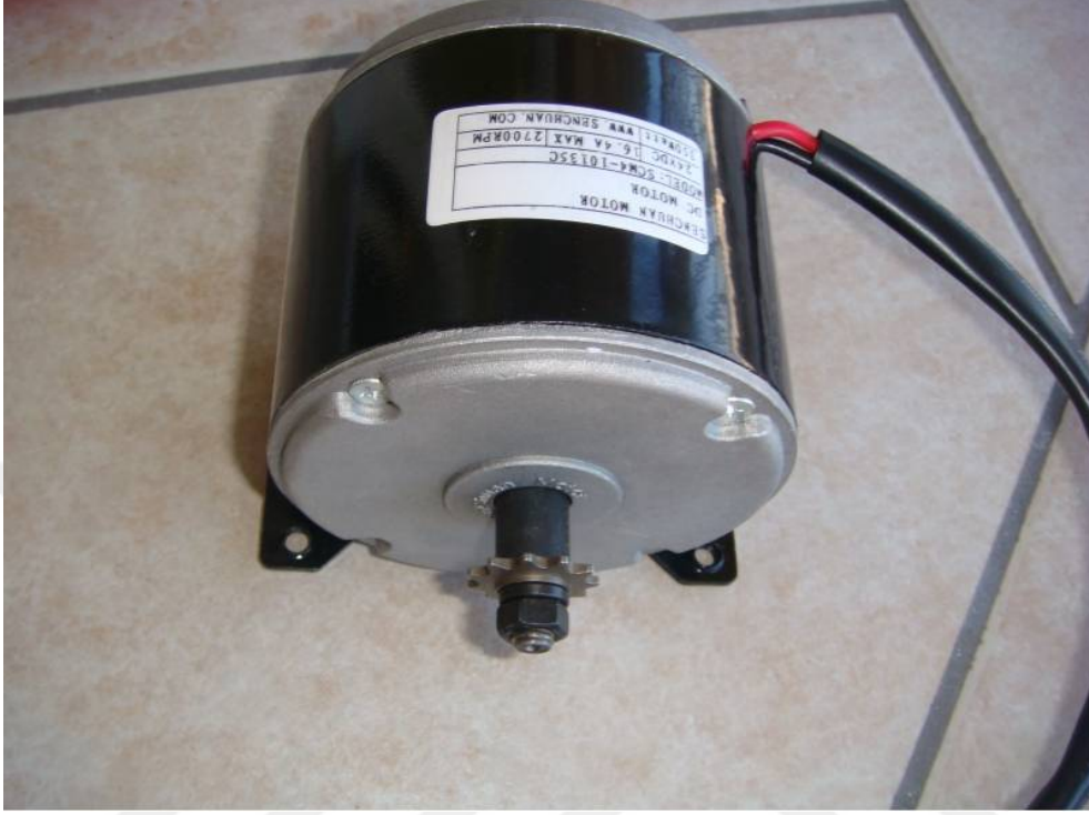
Şekil 3.21. Rüzgar türbininde kullanılan elektrik motoru
