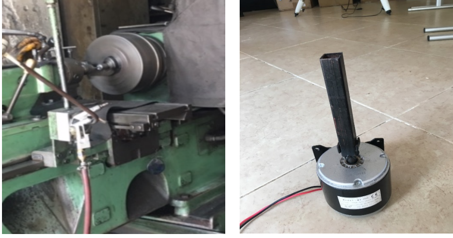
Şekil 3.28. Torna makinasında üretilen aparat ve monte edilmiş motor
