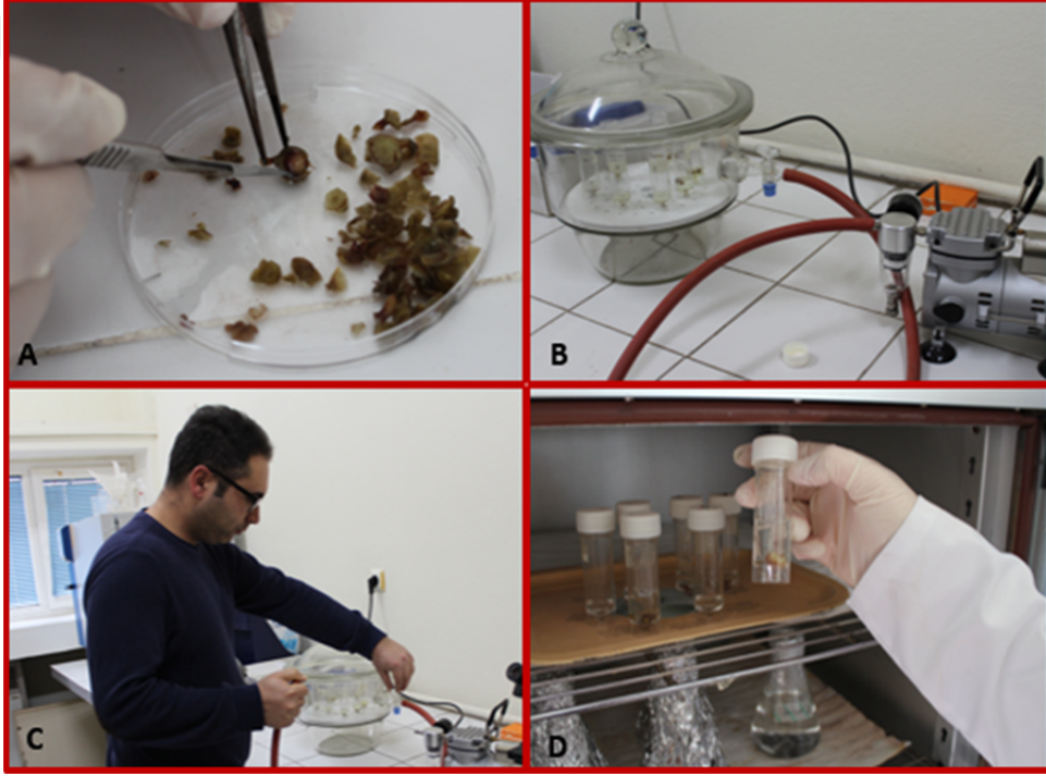
ekil 3.12. iek tomurcuęu iindeki havanın alınması (A: anak yaprakların uzaklatırılması ve tomurcuęun bistri ucuyla delinmesi, B: rneklerin vakum pompası baęlı desikatre yerletirilmesi, C: vakum pompası ile havalarının alınması, D: TBA-1 ierisinde rneklerin etvde bekletilmesi)
