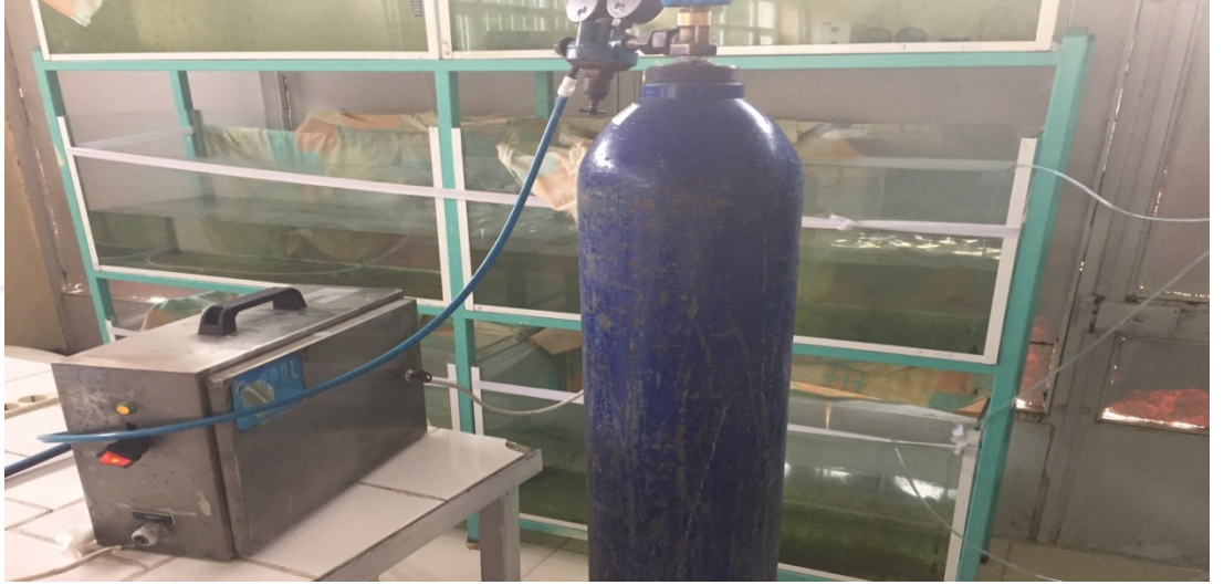
Şekil 3.3. Pestisit kalıntılarını ozon jeneratörü ile giderme
