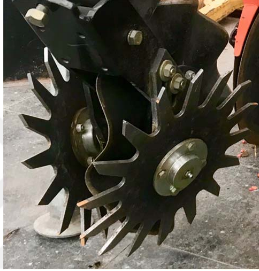
Şekil 3.2. Sap parçalayıcı disk ve yanına monte edilmiş çift çizi temizleyici.
