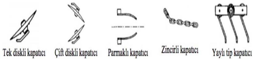
řekil 1.13. Tohum üzerini kapatmada kullanılan deđiřik üniteler (ASABE, 2013).
