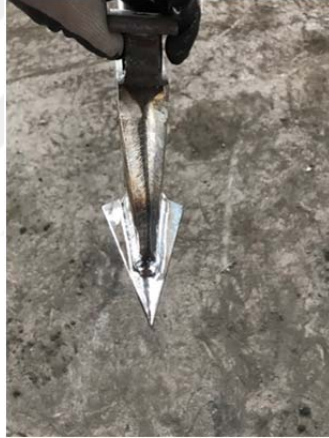
Şekil 3.10. Ters T tipi ayakların imalat aşamalarından bir görünümü.
