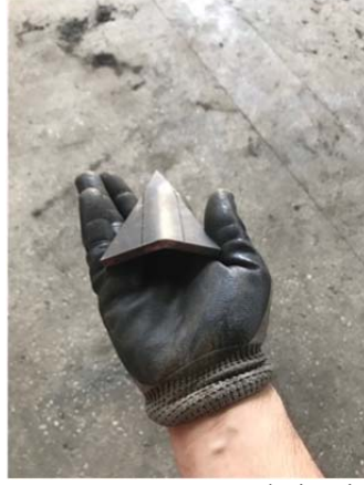
Şekil 3.9. Ters T tipi çizi açıcı ayağın, toprak içerisindeki iz oluşturan kanatın üretim aşaması.
