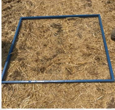
Şekil 3.15. Demir çember ile örneklerin alınımı.
