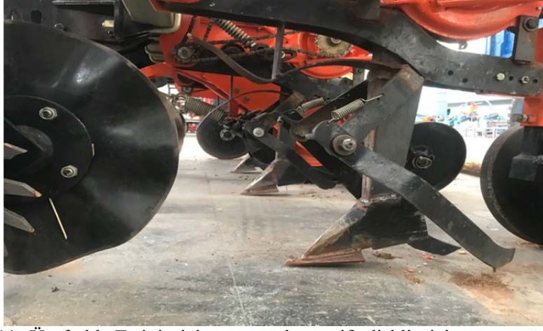
Şekil 3.11. Üç farklı T tipi çizi açıcı ayak ve çift diskli çizi açıcı ayağın monte edilmesi.
