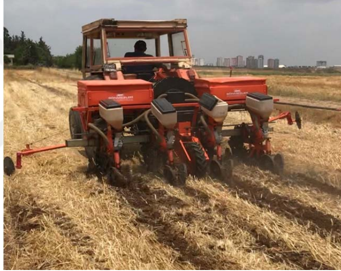
Şekil 3.1. Çalışmada kullanılan dört sıralı pnömatik hassas doğrudan ekim makinası
