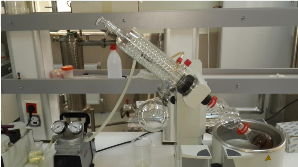
Şekil 3.1. Ekstredeki çözügen (metanol) rotavaporda uçurularak uzaklaştırılması.
