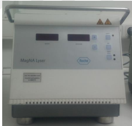
Şekil 15: MagnaLyser ile Doku Homojenizasyonu Prosedürü
