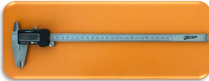
Şekil 3.2. Digital kumpas. (Astor digital kumpas-300 mm)
