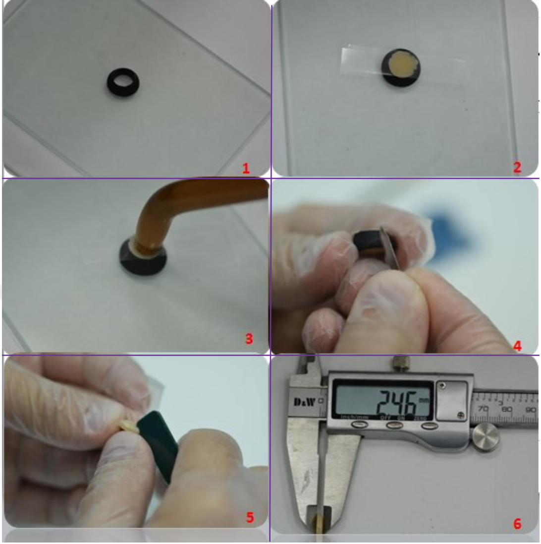
Resim 1: Kazıma testinin yapılışı. 6 mm kalınlığında kalıpların hazırlanması (1). Polimerizasyon derinliği ölçülecek restoratif materyal tek tabaka olarak kalıba tepilmesi, alt ve üst yüzeylere şeffaf bant yerleştirilmesi ve fazlalıkların uzaklaştırılması için kuvvet uygulanması (2). Firmalarca belirtilen şekilde ve sürelerde ışık uygulaması yapılması (3). Örneklerin kalıplardan çıkarılması (4). Sertleşmemiş materyalin plastik kazıyıcı yardımı ile uzaklaştırılması (5). Polimerize olan materyalin kalınlığının/polimerizasyon derinliğinin kumpas yardımı ile ölçülmesi (6).
