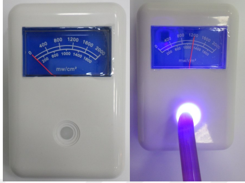
Resim 4: Radyometre cihazı ve ışık cihazı kalibrasyonu
