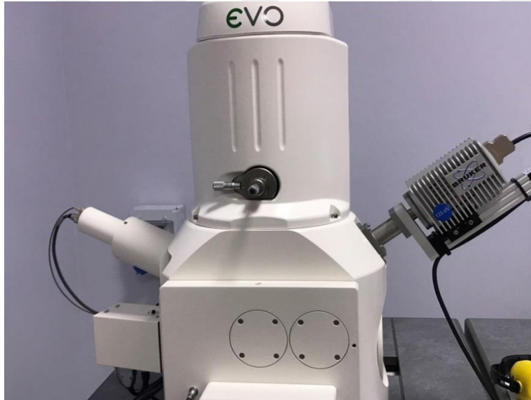
Şekil 3.20. LEO- EVO 40 VP model SEM cihazı
