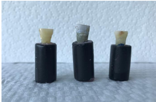
Şekil 3.11. Kırılma dayanımı testi için kalıplara yerleştirilen örnekler (sırayla DAP- TAP- Ca(OH) 2 )
