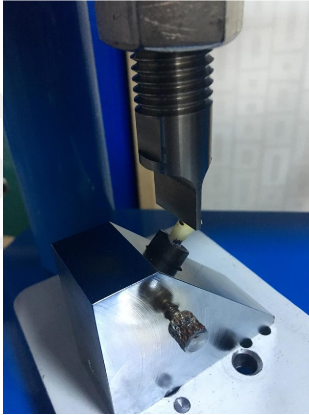
Şekil 3.12. Özel hazırlanmış platforma sabitlenmiş örneğe kırılma dayanımı testi uygulanması
