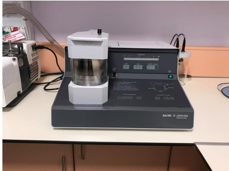
Şekil 3.18. Altın-palladyum kaplama yapan BAL-TEC SCD 050 Sputter Coater cihazı
