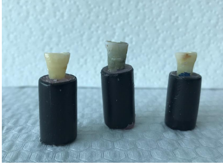
Şekil 4.15. 1 aylık medikaman uygulaması sonrası akrilik bloklara gömülmüş olan K grubu örnekleri (sırasıyla DAP-TAP- \text{Ca}(\text{OH})_2 ) TAP grubuna ait örnekte belirgin renk değişikliği tespit edilmiştir.
