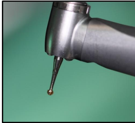
Resim 2: Karbid frezin yivlerini dolduracak miktarda örnek alınması
