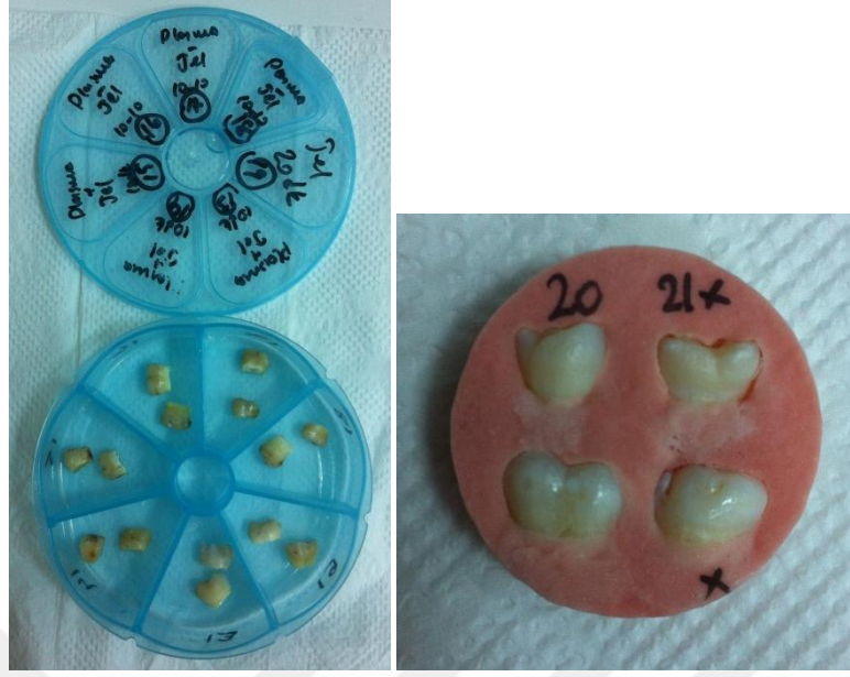
Resim 3.12. SEM analizi için hazırlanan örnekler
