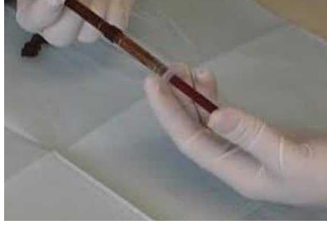
Resim 3.7. % 40 HP jelin karıştırılarak hazırlanması
