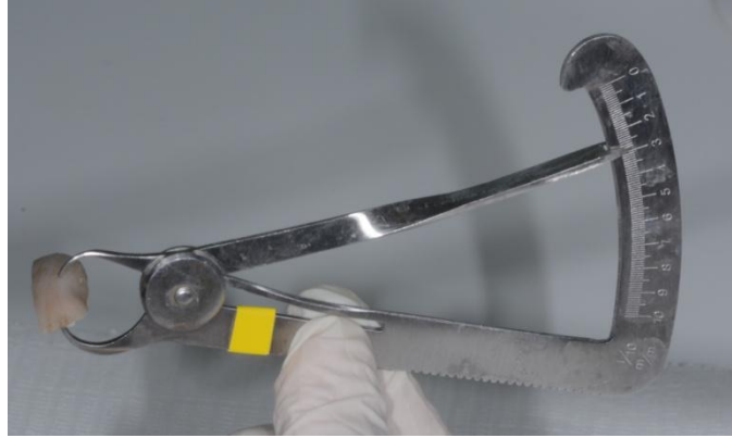
Resim 3.2. Örnek kalınlıklarının kumpas ile ölçülmesi
