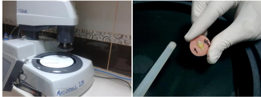
Resim 3.10. Polijaj cihazı ve polijajı yapılmakta olan bir örnek
