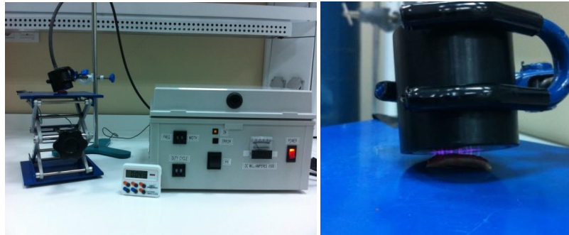
Resim 3.6. Plazma düzeneği ve plazma uygulanan bir örnek
