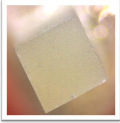
Resim 26: Materyal-rezin siman ara yüzeyinde adeziv kopma tipi
