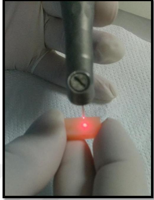
Resim 8: Er:YAG Lazerin örneklere uygulanması
