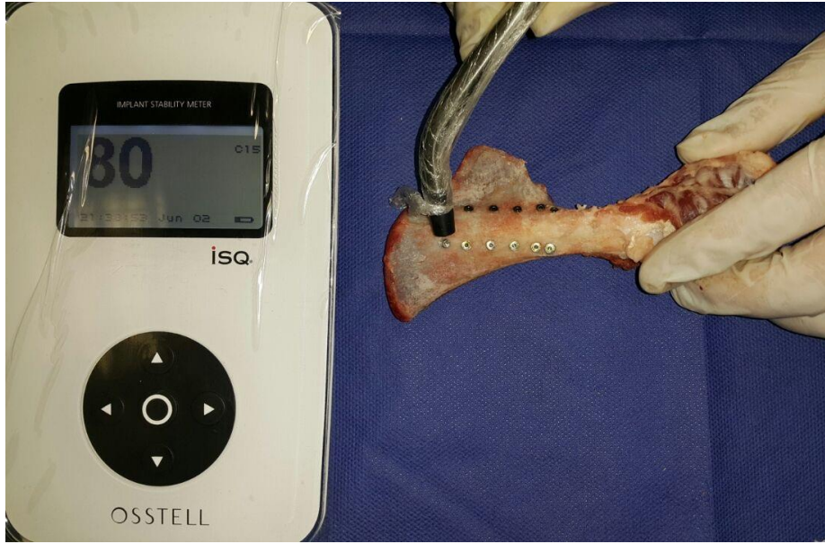
Resim 16: İliak kemiğindeki implantlarda RFA yapılması
