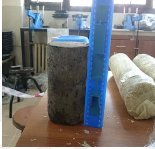
Şekil 4. 8. Tek eksenli (serbest) basınç deneyi için numunenin hazırlanması
