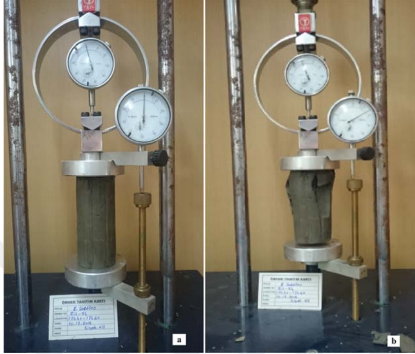
Şekil 4. 13 a) YK-2 numunesinin serbest basınç deneyi öncesi görünümü, b) Sünümlü davranış gösteren YK-2 numunesinin serbest basınç deneyi sonrası görünümü
