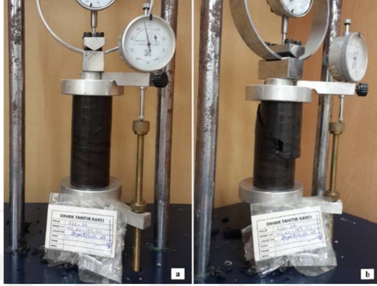
Şekil 4. 11 a) SK-4 numunesinin serbest basınç deneyi öncesi görünümü, b) Kırılgan davranış gösteren SK-4 numunesinin serbest basınç deneyi sonrası görünümü
